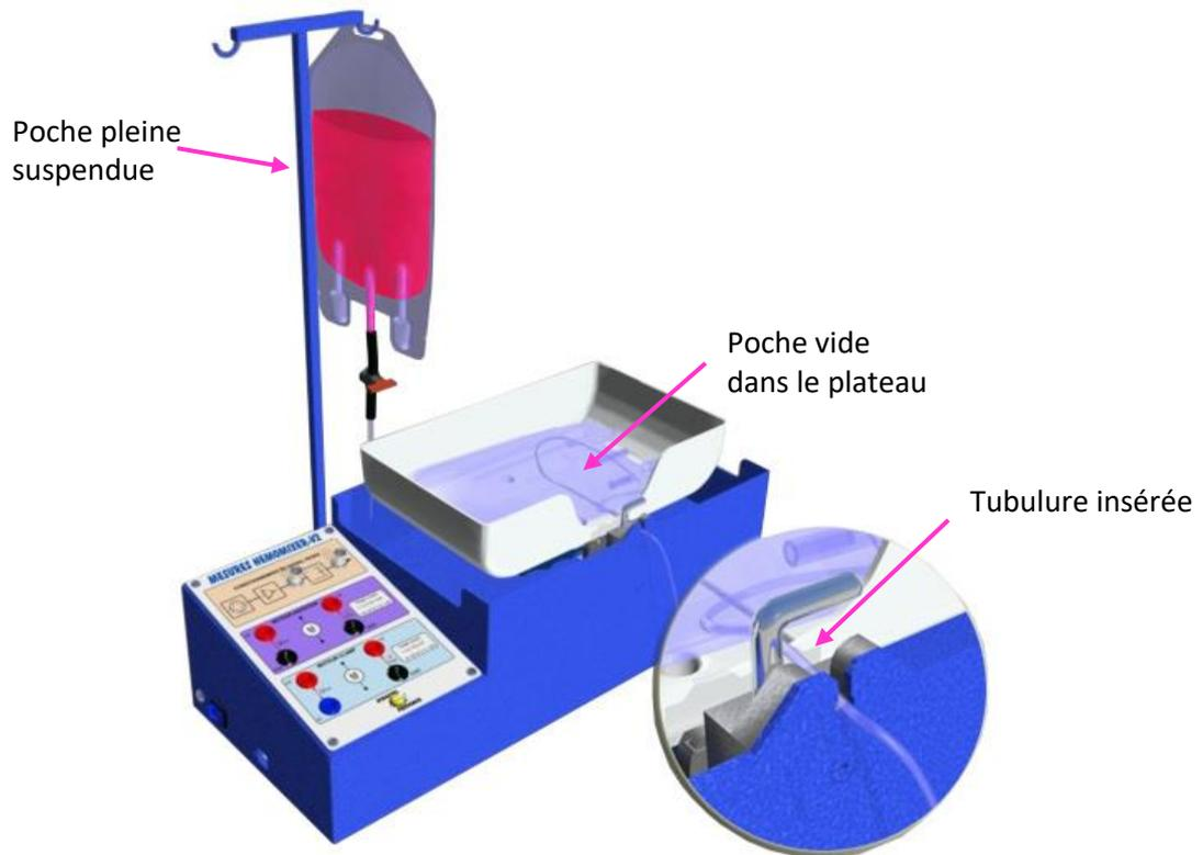
La tubulure est sous pression et le liquide va pouvoir s'écouler une fois le cycle de prélèvement lancé.
