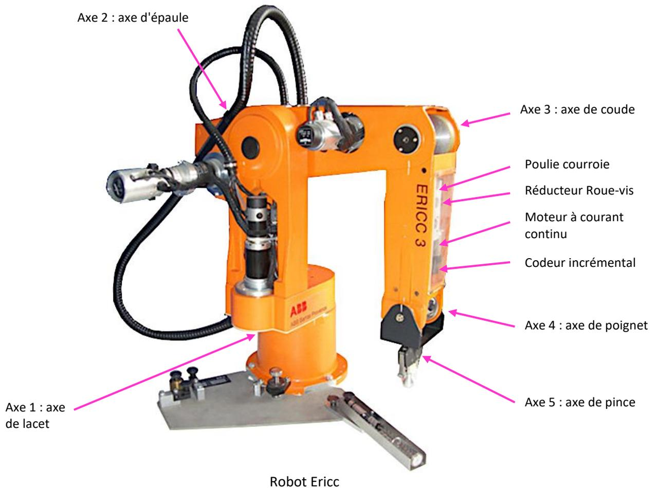
On s'intéresse ici à l'asservissement de l'axe 4 du robot Ericc : axe de poignet.
