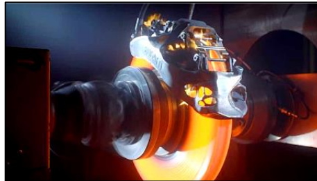
Banc de test du frein
