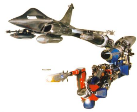
Installation de trajectographie captive
