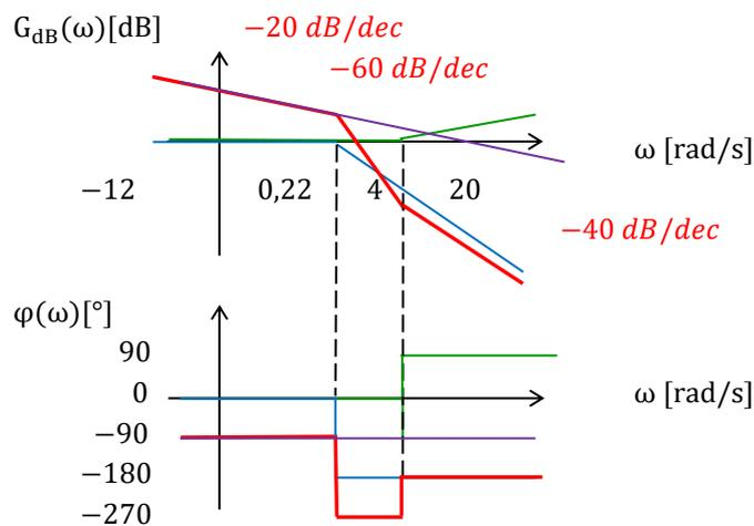
On peut calculer la phase minimale de la courbe réelle pour  $\omega = 1 \text{ rad/s}$  :
