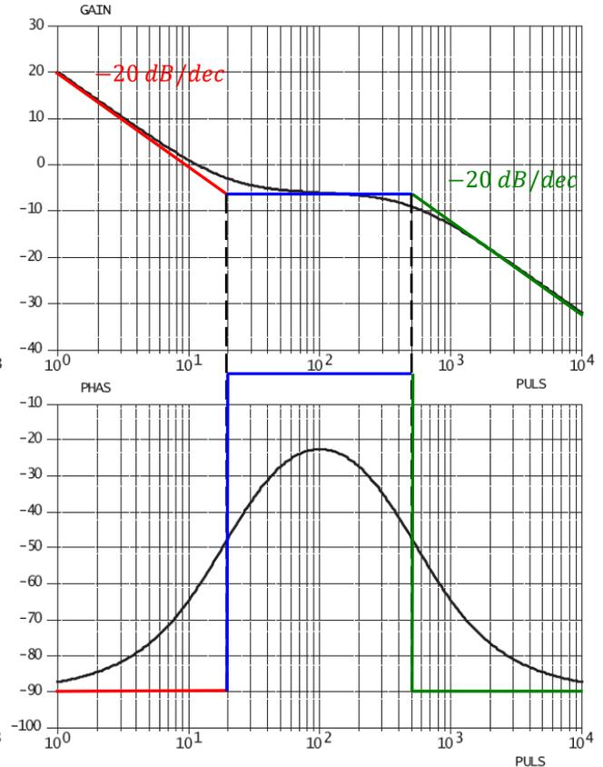
On lit graphiquement  $\omega_{c1} \approx 1 \text{ rad/s}$  et  $\omega_{c2} \approx 100 \text{ rad/s}$  On lit graphiquement  $\omega_{c1} \approx 20 \text{ rad/s}$  et  $\omega_{c2} \approx 500 \text{ rad/s}$
