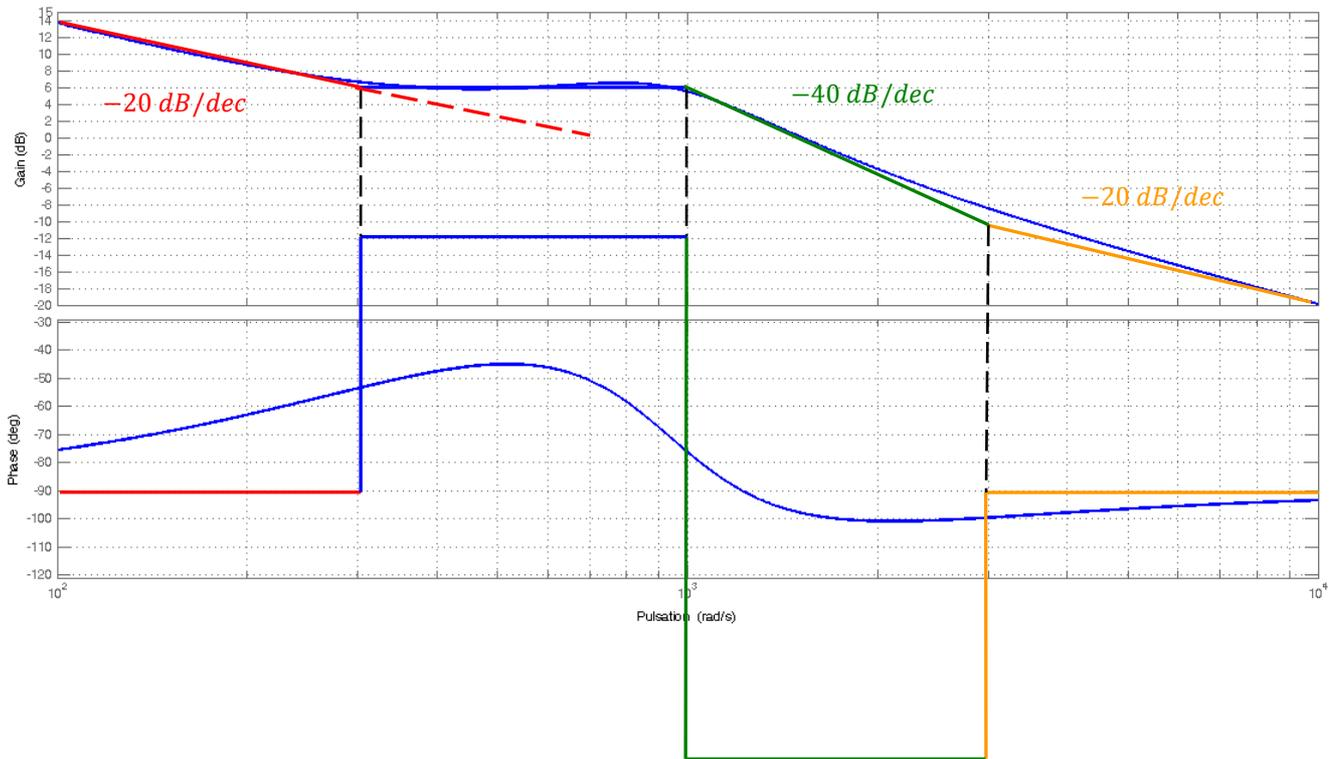
On lit graphiquement  $\omega_{c1} \approx 300 \text{ rad/s}$ ,  $\omega_{c2} \approx 1000 \text{ rad/s}$  et  $\omega_{c3} \approx 3000 \text{ rad/s}$
