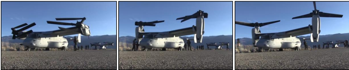
FIGURE 2 - Déploiement des moteurs, puis des pales
