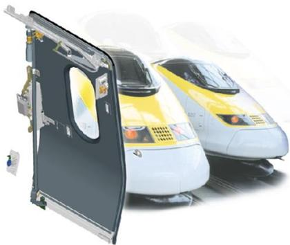
La figure de droite montre l'interface assurant, à partir des informations délivrées par l'unité centrale de commande, la fermeture hermétique et le verrouillage d'une porte de TGV.
