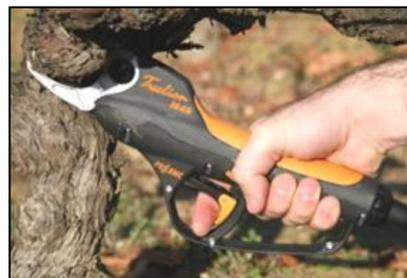
Ce système se compose d'une batterie (portée à l'aide d'un harnais par l'utilisateur) alimentant un sécateur par un cordon.
