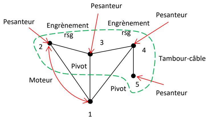
**Remarque :** on a besoin d'un graphe de structure pour les puissances.
