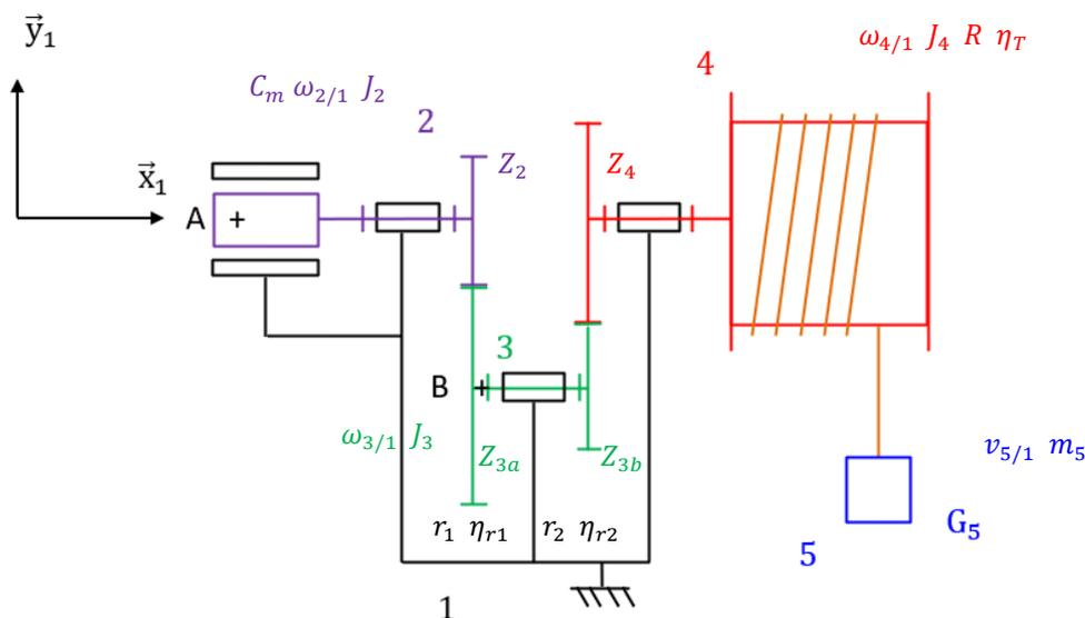
**Question 2 :** Déterminer la relation entre  $v_{5/1}$  la vitesse de déplacement de la charge par rapport au bâti et  $\omega_{2/1}$  la vitesse de rotation du moteur.
