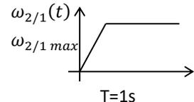
$$C_m = \frac{1}{\eta} \left( J_{eq} \dot{\omega}_{2/1} + m_5 g R \frac{Z_2 Z_4}{Z_{3a} Z_{3b}} + \mu \left( \frac{Z_2 Z_4}{Z_{3a} Z_{3b}} \right)^2 \right) = \frac{1}{0,9 \cdot 0,9} \left( 0,0102 \cdot 146,6 + 100 \cdot 9,81 \cdot 0,1 \frac{15 \cdot 15}{150 \cdot 90} + 0,1 \left( \frac{15 \cdot 15}{150 \cdot 90} \right)^2 \right)$$
