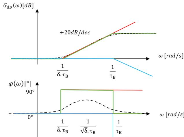
**Remarque :** Pour cette correction, nous tracerons aussi le diagramme réel. Cette fonction de transfert réalise une avance de phase.
