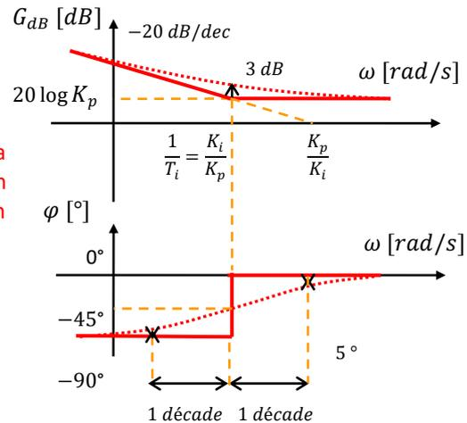
**Question 6 :** Déterminer graphiquement puis analytiquement les paramètres  $K_p > 1$  et  $K_i > 1$  du correcteur par la méthode du placement fréquentiel.
