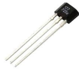
Détecteur à effet Hall (capteur de proximité TOR)
