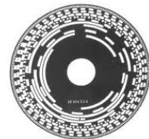
Disque et pistes d'un codeur absolu
