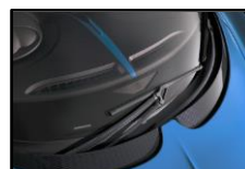
Les trajectoires du balai des essuie-glaces par rapport au châssis sont des arcs de cercles
