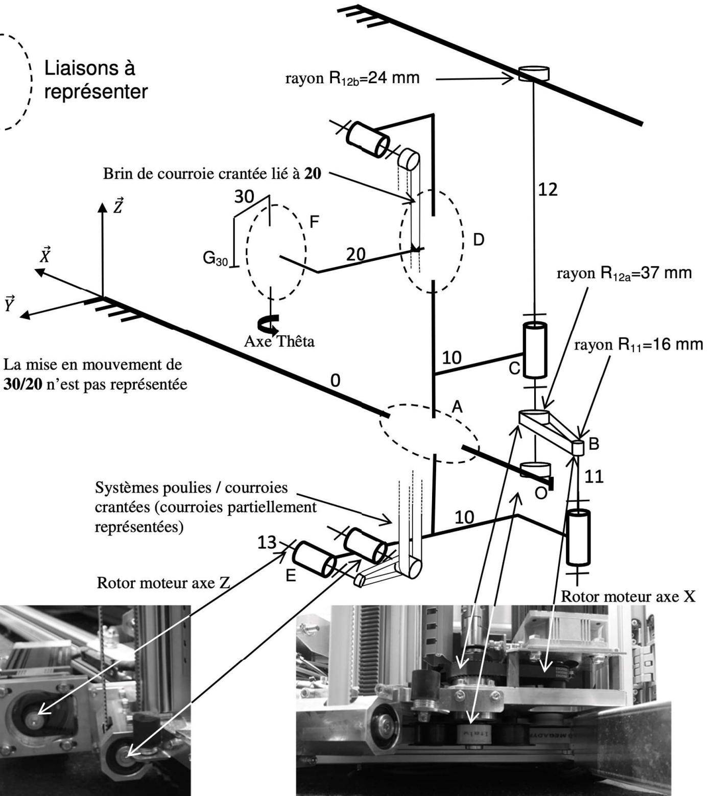
Figure A Schéma cinématique minimal
