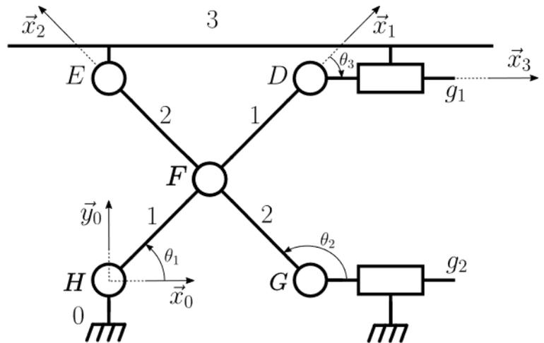
Figure 22 – Schéma cinématique paramétré d'une structure ciseaux
