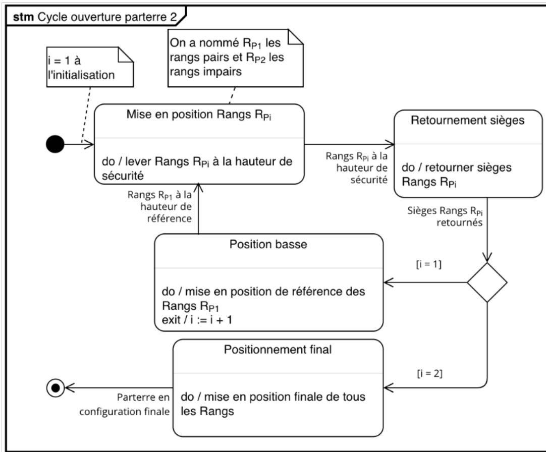
Figure 14 – Diagramme d'état : déploiement des gradins en deux temps
