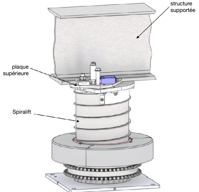
**Figure 37** – Vue 3D de l'ensemble d'un vérin Spiralift
