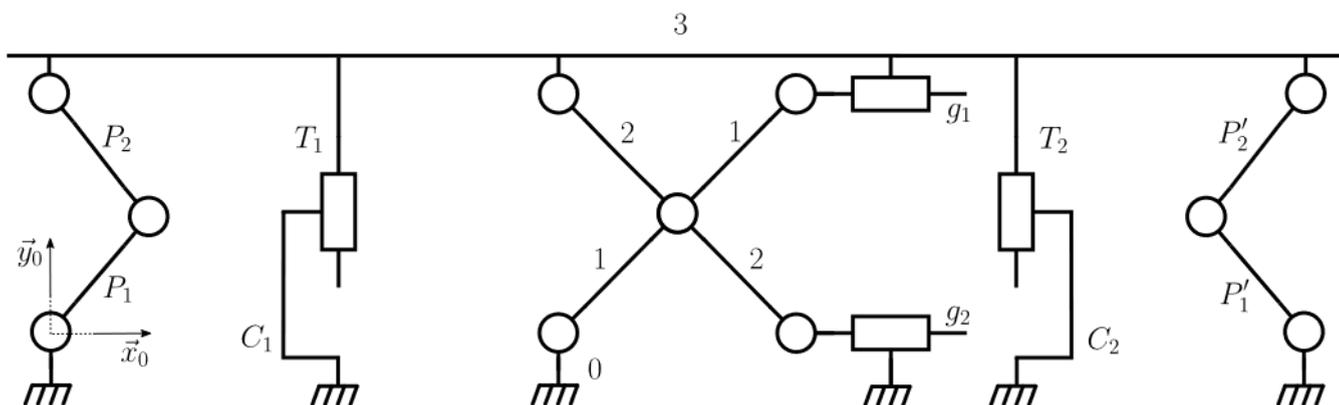
**Figure 23** – Schéma cinématique d'un module du gradinage d'orchestre
