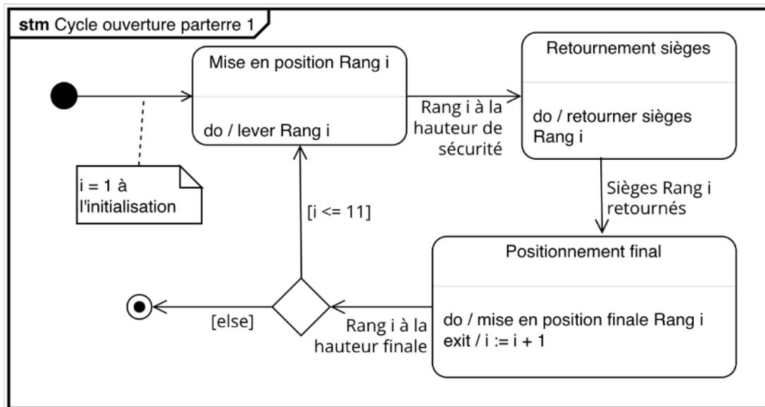
Figure 13 – Diagramme d'état : déploiement rang par rang des gradins
