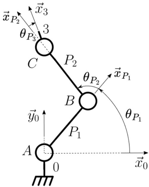
Figure 19 – Schéma cinématique paramétré d'une poutre
