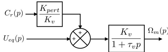
**Figure 32** – Schéma-blocs de la modélisation du moteur équivalent
