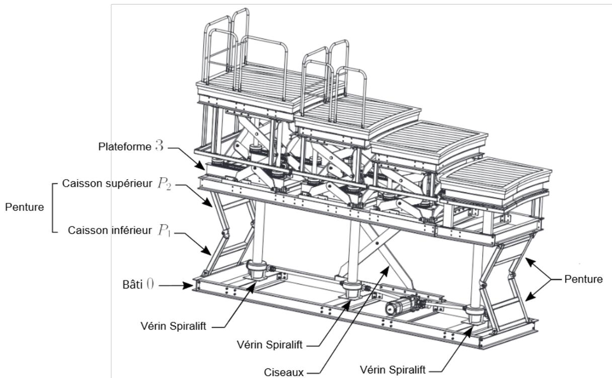
**Figure 16** – Vue globale de la structure mécanique du module de gradinage d'orchestre. On distingue les 2 pentures, les ciseaux et les 3 vérins Spiralift. Seule la partie inférieure du gradinage est étudiée (extrait de dessin technique constructeur)
