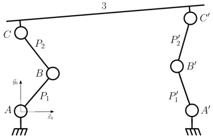
Figure 20 – Schéma cinématique de deux poutres en parallèle
