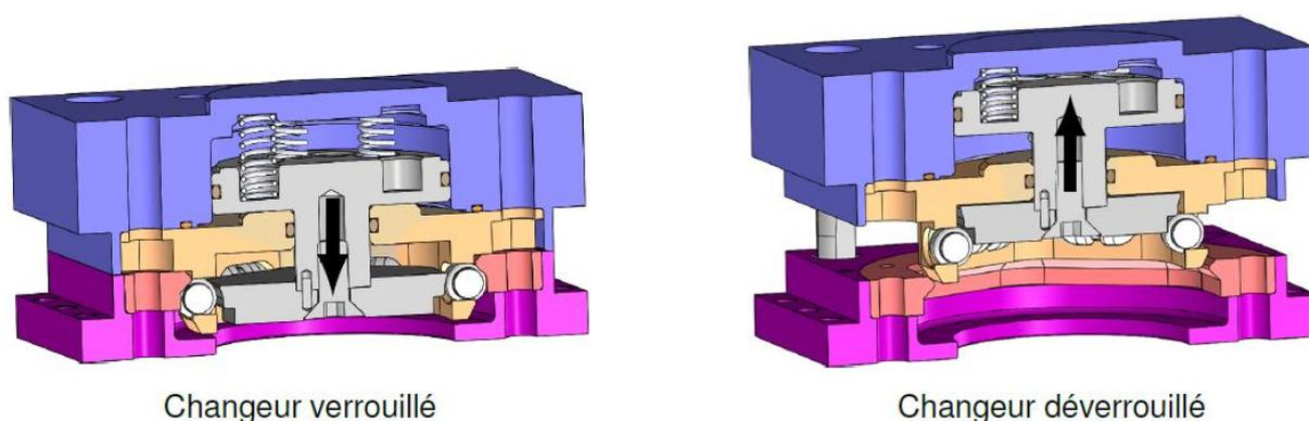
Figure 37 - Les 2 positions du changeur d'outil automatique
