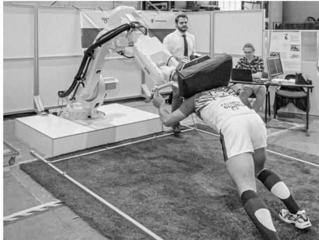
Figure 3 - Joug de mêlée robotisé Strongarm en phase d'essai
