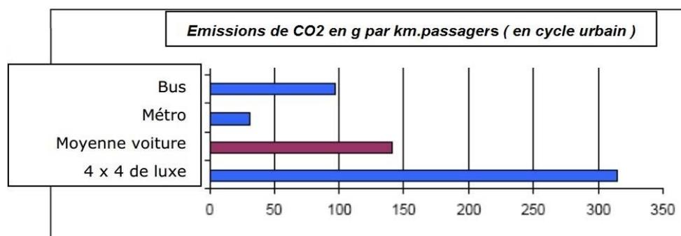
Question 1.6 | À partir du rejet de CO<sub>2</sub> sur le trajet type, du profil des lignes et du taux d'occupation, le niveau de rejet de CO<sub>2</sub> par km et par passager est estimé à 53 g pour le réseau de tramways de Reims. **Conclure** en comparant les différents modes de transport.
