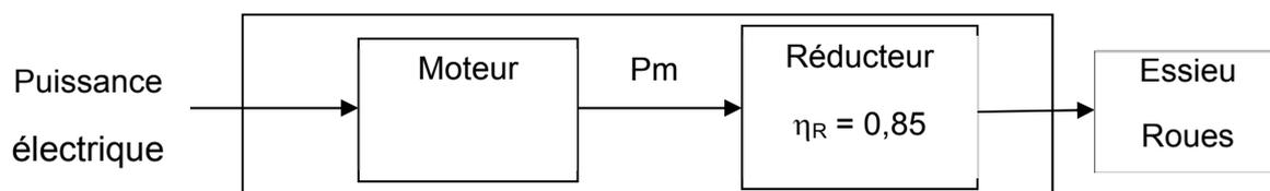
La transmission du couple nécessite l'usage d'un réducteur.
