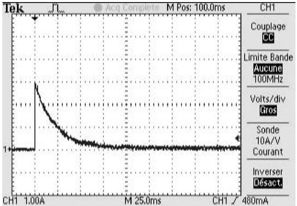
**Figure D** Mesures des intensités consommées par la machine à courant continu de l'axe d'azimut en phase de démarrage sous des échelons de tension d'amplitude croissante — Échelle horizontale : 1 carreau = 25 ms ; échelle verticale : 1 carreau = 1 A
