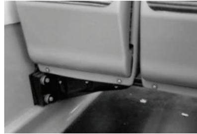
Figure 14 : détail de la fixation des banquettes sur la paroi du train
