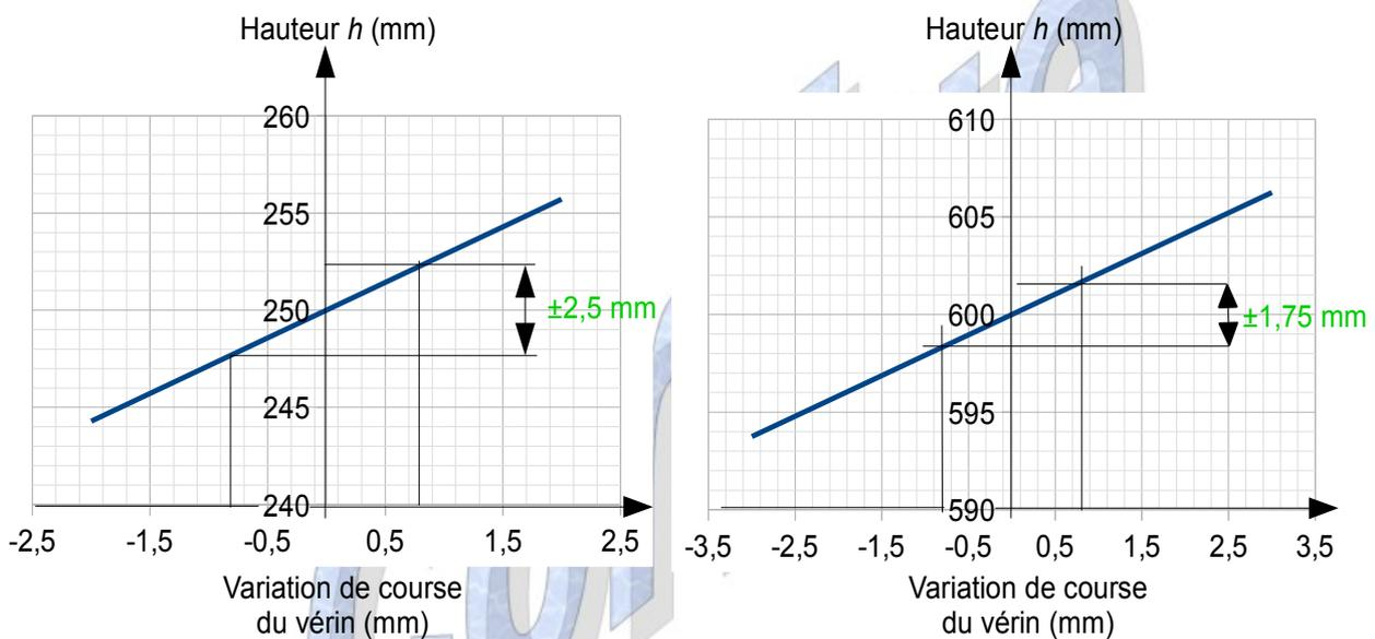
Pour  $h_{\text{mini}}=250\text{mm}$ , l'écart de positionnement de  $h$  relevé est :
